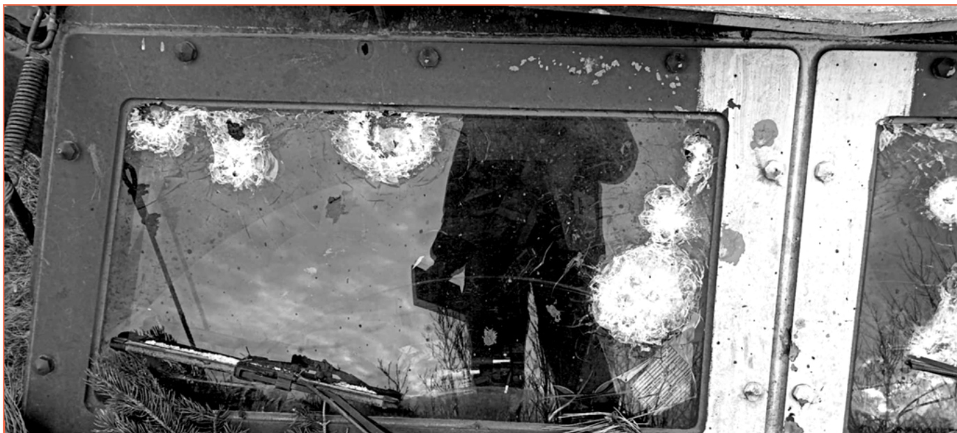
Потрочене броньоване скло “Козака” все ще не привід здавати авто в ремонт, бо інакше доведеться надовго залишитися без “броні”
